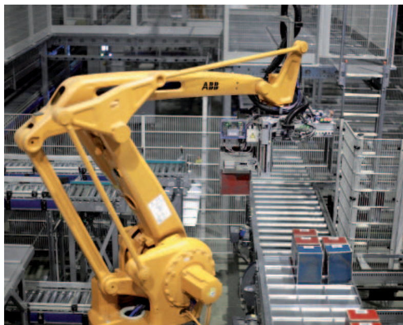
Bild 1: Momentaufnahme. Die 6-Achs-Knickarmroboter sind auf das Handling von zwei unterschiedlichen Kartontypen ausgelegt. Von den 2 016 000 Kartons im Lager greift die Sberbank auf etwa 240 000 am häufigsten zu
