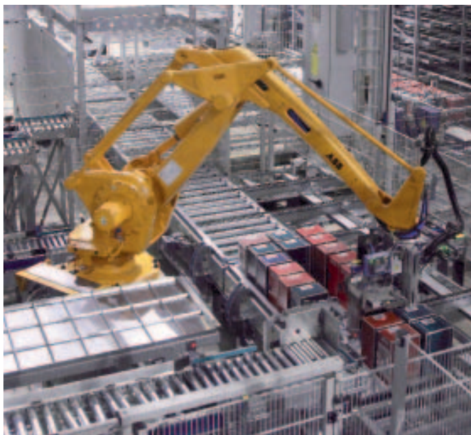
Bild 1: Momentaufnahme. Die 6-Achs-Knickarmroboter sind auf das Handling von zwei unterschiedlichen Kartontypen ausgelegt. Von den 2 016 000 Kartons im Lager greift die Sberbank auf etwa 240 000 am häufigsten zu
